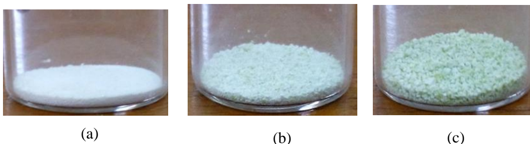
Gambar 1. Padatan hasil sintesis: (a) MOF-5 (3), (b) MOF-5 (1,5), (c) Ni-MOF-5 (0,05), dan Ni-MOF-5 (0,1)
