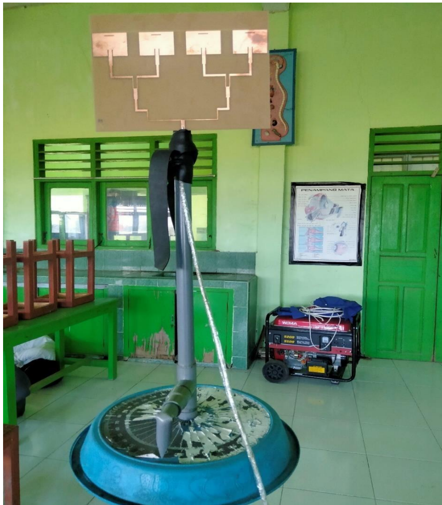
Gambar 18. Pengukuran kelayakan dan kemampuan antena
